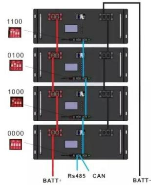
BMS Wiring Diagram
